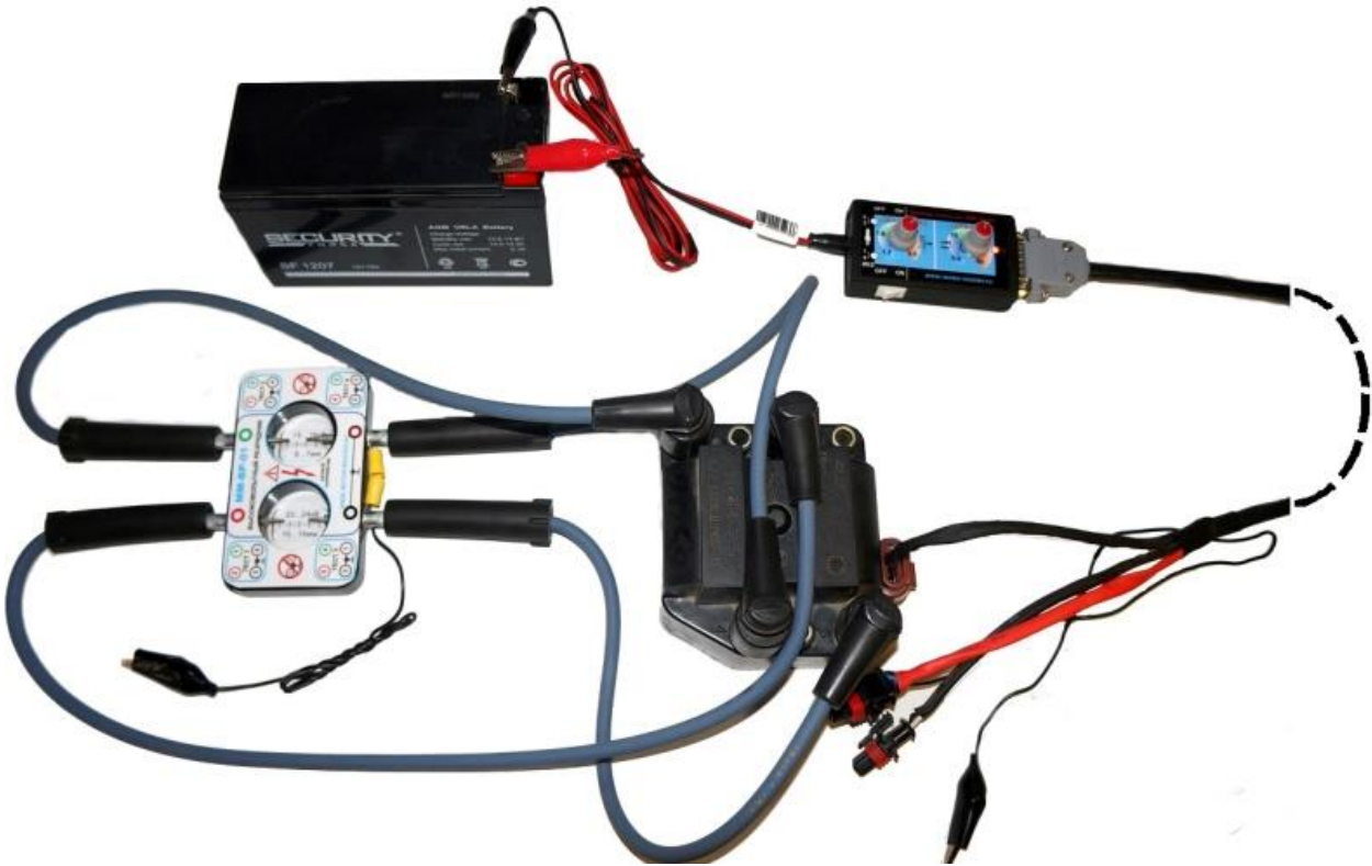
Рис. 11. Пример подключения к модулю зажигания ВАЗ с помощью специального кабеля
