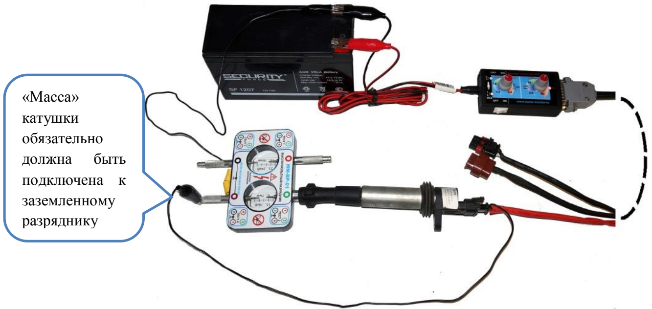
Рис. 13. Пример подключения к ИКЗ ВАЗ с помощью специального кабеля.
